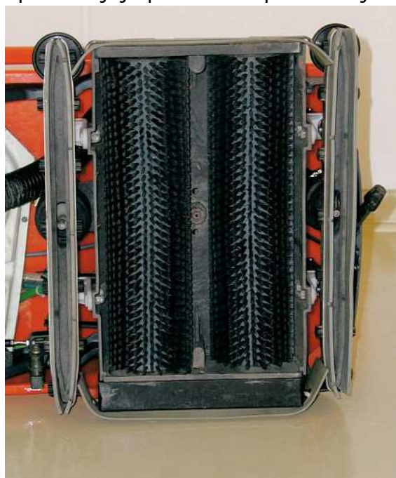
Avtomatika sesalne šobe in dvojna kontra rotirajoča valjčna ščetka (PP) sta optimalno naravnana za čiščenje
